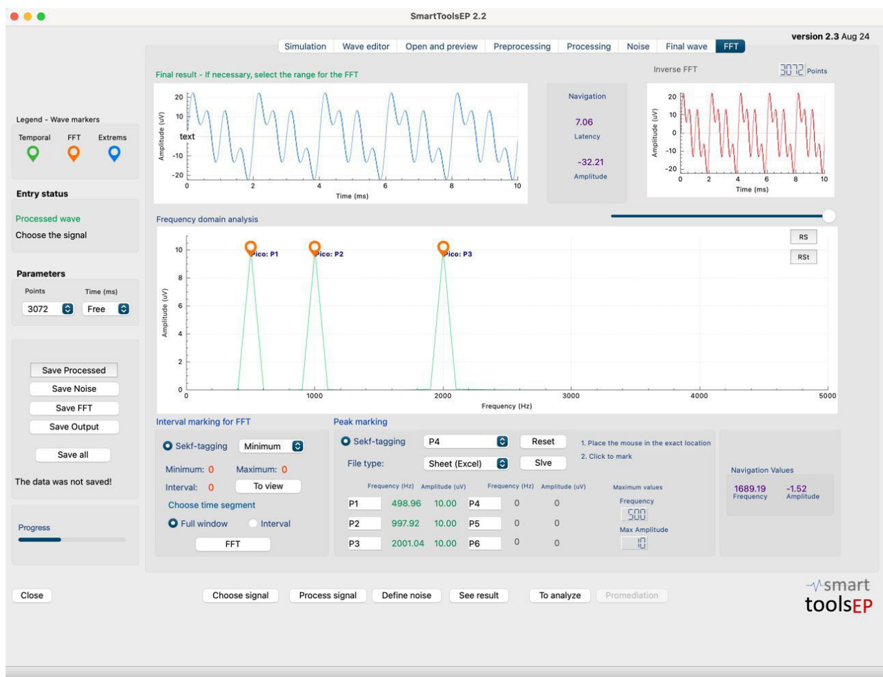
Figura 3. Tela de marcação dos picos de frequência do aplicativo STEP. Exemplo de picos marcados para a onda somatória (0,5, 1 e 2 kHz)
