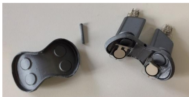
Figura 2. Interior do instrumento, mostrando os quatro sensores posicionados em cada quadrante
